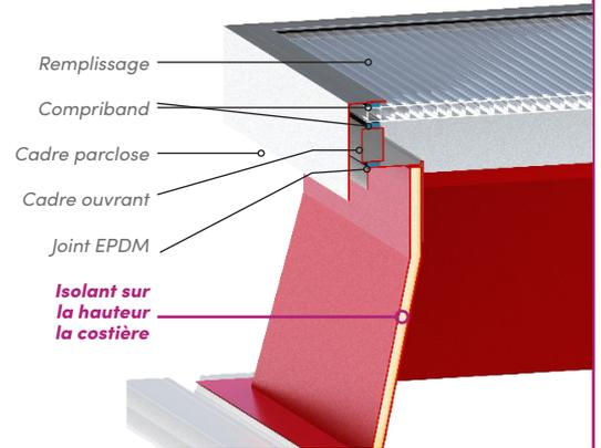
**Performances thermiques  $U_{RC}$  (W/m<sup>2</sup>.K) ET  $A_{RC}$  (m<sup>2</sup>)**
